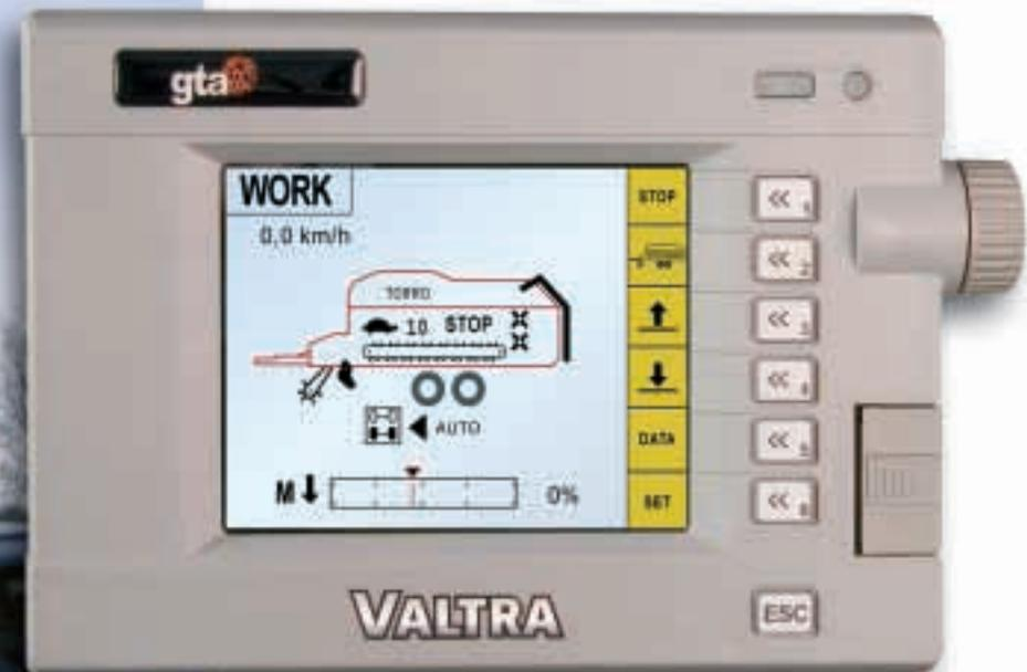
Valtra ISOBUS -communicatie systeem verbindt de trekker, het werktuig en de ISOBUS terminal met elkaar. Het ISOBUS wisselt een groot aantal met gegevens uit van de trekker naar het werktuig en omgekeerd. Het aantal met ISOBUS uitgeruste werktuigen neemt zeer snel toe.
